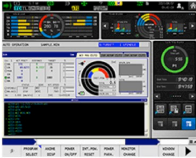
Figura 3: Tela de operação do ECO Power Monitor, visto aqui em uma tela de 19 polegadas.
